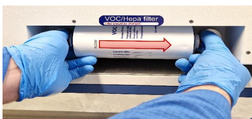
Slika 12.2 Postopek vstavljanja in odstranjevanja filtra VOC/HEPA
