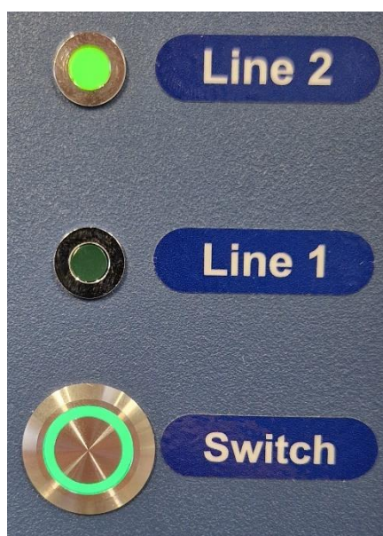
Slika 20.4 Stikalo za preklop linije na večprostorskem inkubatorju za IVF MIRI® TL12 in aktivna linija 1
