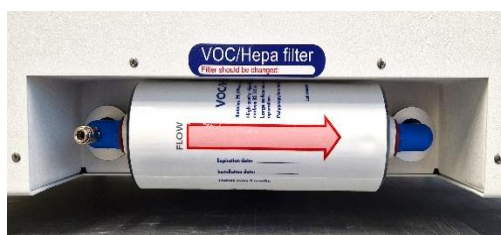
Slika 12.3 Pravilno nameščen filter VOC/HEPA
