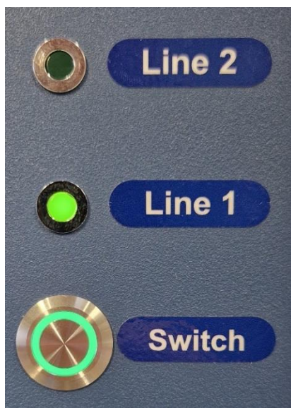
Slika 20.2 Stikalo za preklon linije na večprostorskem inkubatorju za IVF MIRI® TL12 in aktivna linija 1
