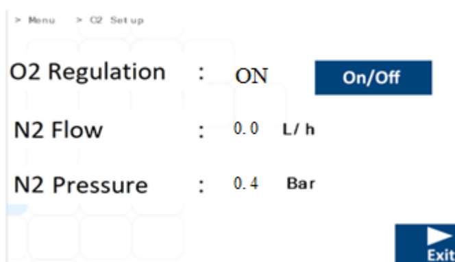
Slik 13.26 Pogled podmenija Nastavitev O 2 na večprostorskih inkubatorjih za IVF MIRI® TL6 in MIRI® TL12
